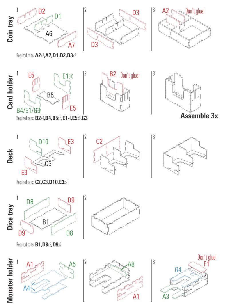
Required parts: A1x2,A3,A4x2,A5,A8,F1,G4
